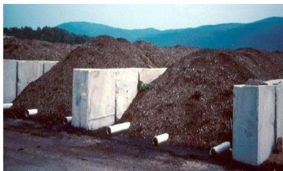
Hình 2.5. Ủ rác thành đồng, thổi khí cưỡng bức
