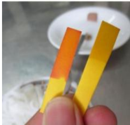
Hình 8.1. Màu của giấy nghệ chuyển sang đỏ cam khi có borat trong dung dịch thử
