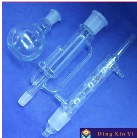
Hình 11.1. Các bộ phận của bộ chiết Soxhlet
