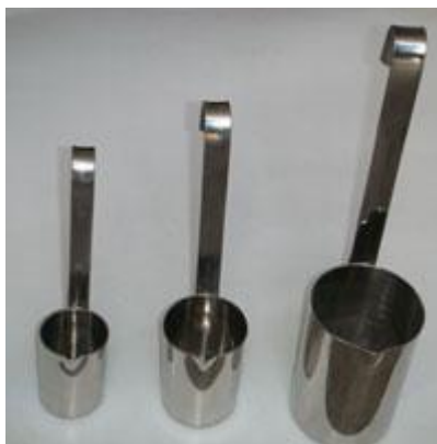
Hình 2.3. Gáo có cán dài lấy mẫu sản phẩm lỏng
