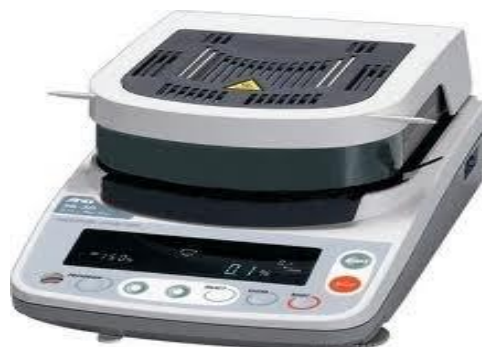
Hình 2.13. Máy đo độ ẩm hồng ngoại
