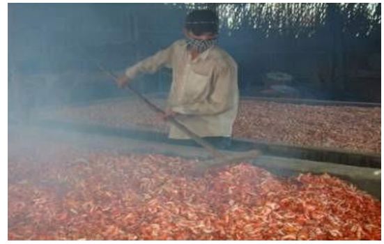
Hình 3.22. Đảo trở tôm khi làm khô Hình 3.23. Sấy tôm bằng hầm sấy đơn bằng bàn cào giàn
