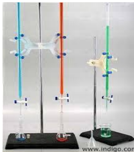
Hình 1.15. Buret chứa chất lỏng
