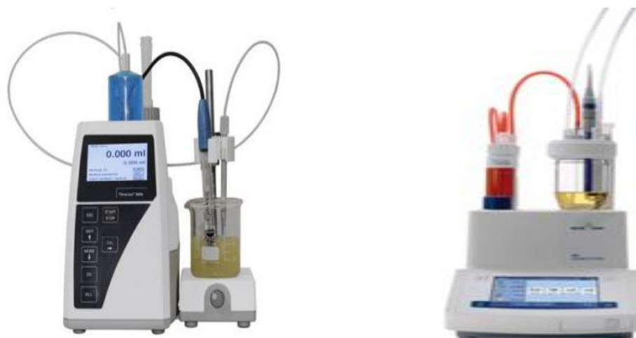
Hình 6.1. Máy chuẩn độ điện thế
