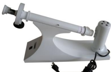
Hình 4.2. Phân cực kế thủ công
