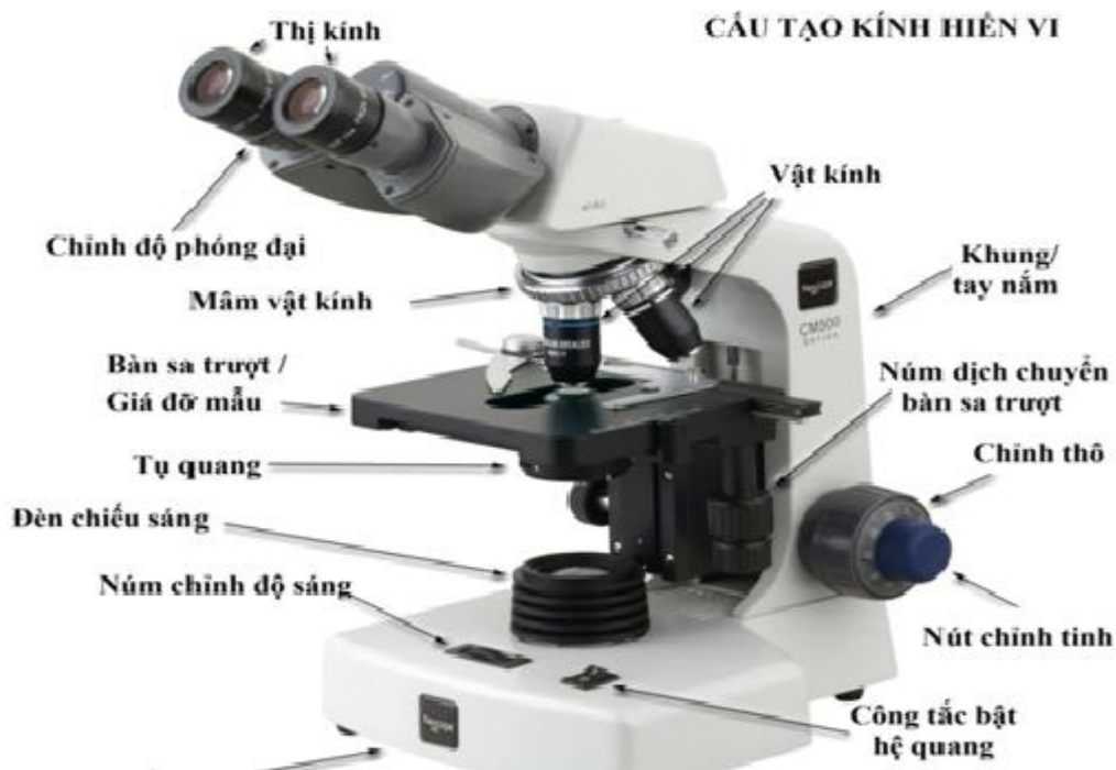
Hình 13.4. Cấu tạo của kính hiển vi hai mắt
