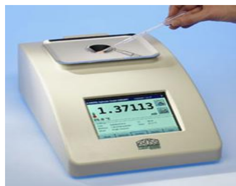
Hình 11.4. Khúc xạ kế để bàn tự động
