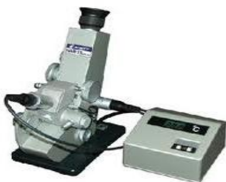
Hình 11.3. Khúc xạ kế để bàn thủ công
