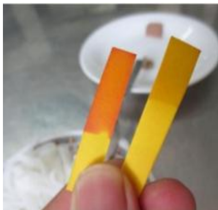
Hình 11.3. Màu của giấy nghệ chuyển sang đỏ cam khi có borat trong dung dịch thử
