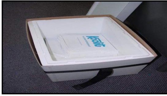
Hình 1.3. Thùng đựng mẫu và túi đá đã chuẩn bị bảo quản mẫu thủy sản
