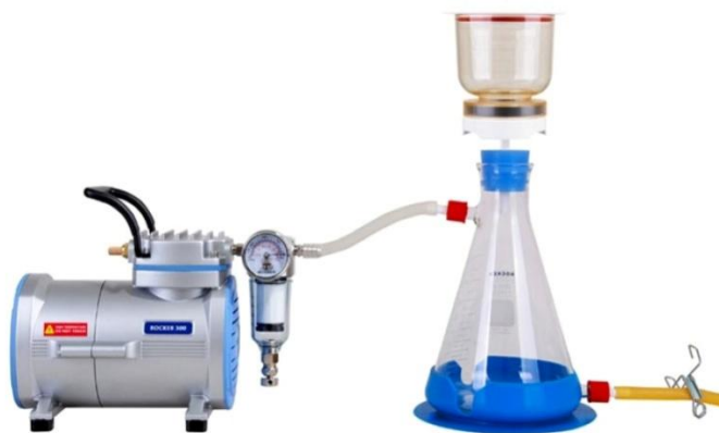
Hình 5.6. Hệ thống lọc hút chân không
