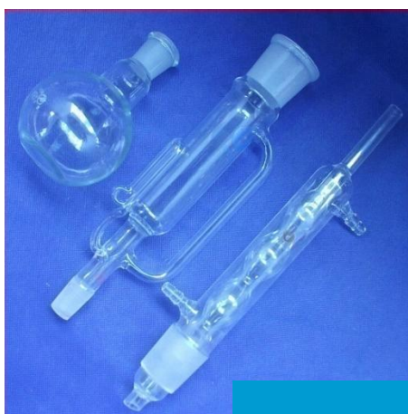
Hình 4.3. Các bộ phận của bộ chiết Soxhlet: Bình cầu, ống chiết, ống sinh hàn (từ trái sang)
