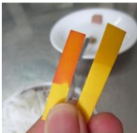
Hình 6.2. Màu của giấy nghệ chuyển sang đỏ cam khi có borat trong dung dịch thử
