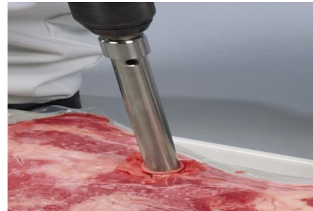
Hình 2.12. Dụng cụ khoan lấy mẫu thịt đông
