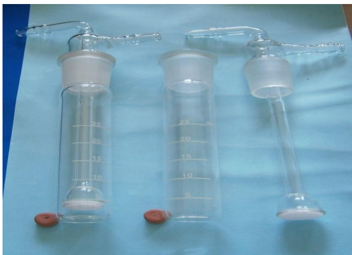
Hình 1.10. Dụng cụ lấy mẫu dạng khí
