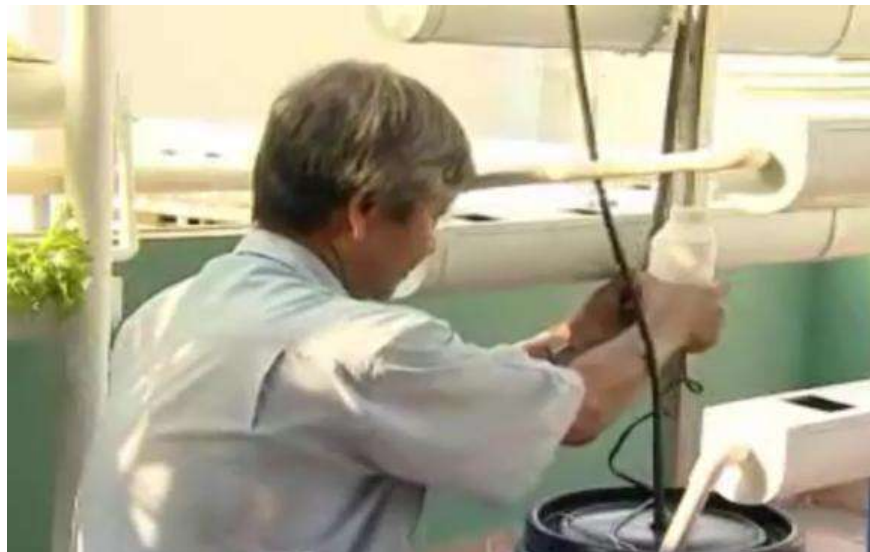
Hình 1.1.89: Lắp ghép hệ thống cung cấp dinh dưỡng
