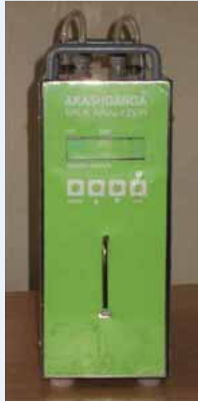
Hình 2.4: Máy phân tích nhanh một số chỉ tiêu chất lượng sữa
