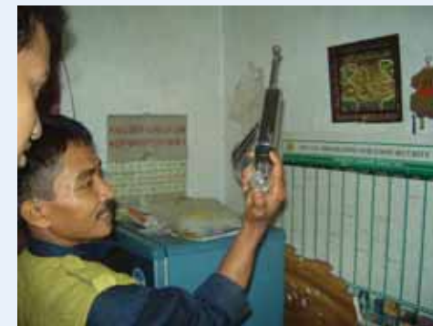
Hình 3.6: Kiểm tra cồn tại trạm thu gom
