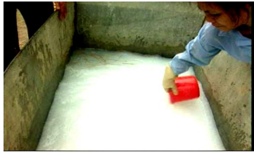
Hình 3.5. Đổ nước vôi vào bể
