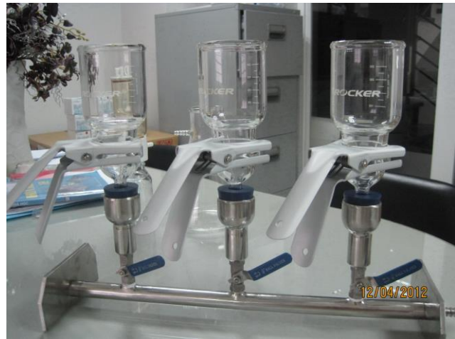
Hình 3.9. Hệ thống màng lọc
