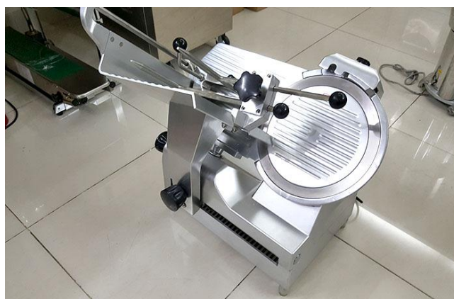
Hình 2.19. Máy cắt thịt
