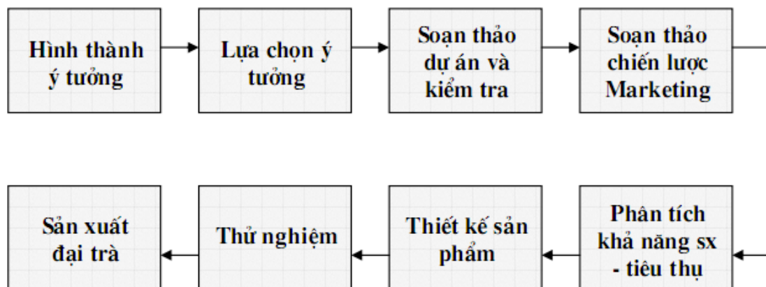
Hình 9: Những giai đoạn chính của quá trình thiết kế sản phẩm mới
